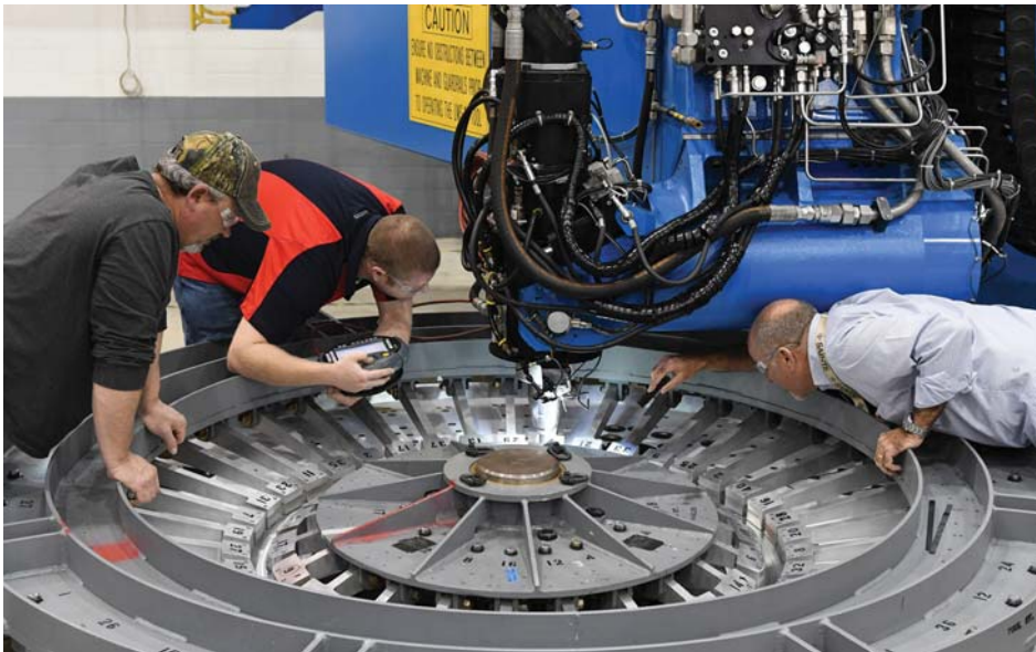
טכנאים של לוקהיד מרטין ריתכו יחד את שני הרכיבים הראשונים של תא אנשי הצוות בחללית אוריון.
